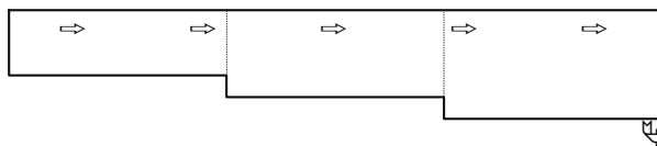
Stufengefälle (Rinnenkörper mit unterschiedlichen Bauhöhen)
