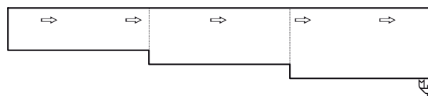
Stufengefälle (Rinnenkörper mit unterschiedlichen Bauhöhen)
