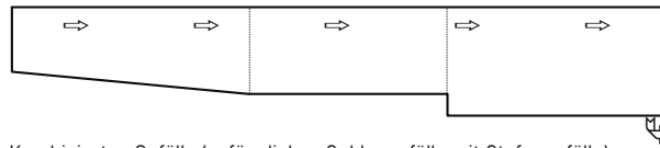
Kombiniertes Gefälle (anfängliches Sohlgefälle mit Stufengefälle)
