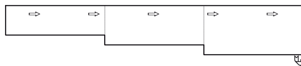
Stufengefälle (Rinnenkörper mit unterschiedlichen Bauhöhen)
